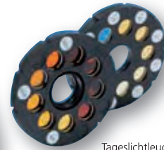
Tageslichtleuchte mit Comparator und Farbscheiben, Netzbetrieb
