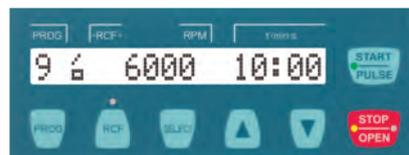
Die Zentrifugenmodelle EBA 280 und EBA 280S sind mit der M-Steuerung ausgestattet. Hierbei werden die Parameter mit der Select-Taste angewählt, die gewünschten Werte mit Pfeiltasten eingestellt und durch Drücken der Start/Pulse-Taste gespeichert.
