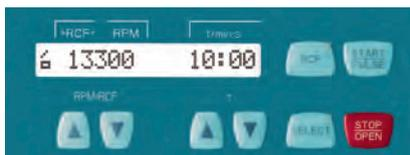
Die Bedienung der Modelle EBA 200, EBA 200S, HAEMATOKRIT 200 und MIKRO 185 erfolgt mit der E Plus-Steuerung. Im Unterschied zur E-Steuerung können die Drehzahl (RPM) oder die relative Zentrifugalbeschleunigung (RCF) eingestellt werden.
