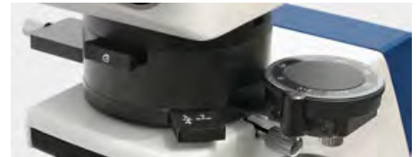
Bertrand-Linse, \lambda Slip, 360° rotierbarer Analysator (herausnehmbar)
