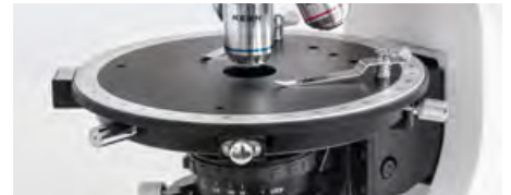
Zentrier- und drehbarer Polarisations-Objektstisch
