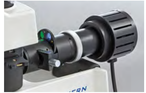
Beleuchtungseinheit mit Filterrad
