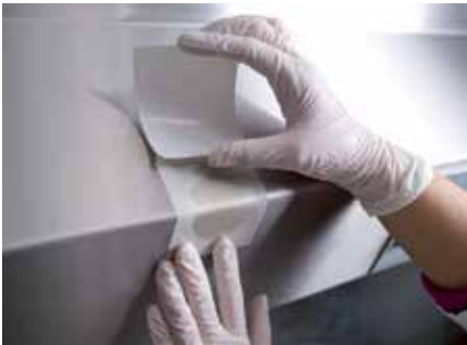
Abbildung 1. Beispiele für direkten Kontakt mit dem Medium und für Tupferproben unter Verwendung von 3M™ Petrifilm™ Platten
