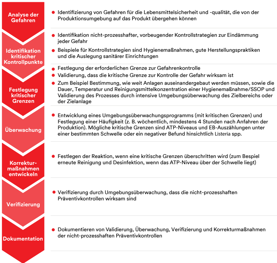
Abbildung 2. Ein auf dem HACCP-Konzept beruhender Ansatz zur Umgebungsüberwachung
