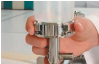
(A) Sorgfältiges Abdichten von Trichter und Membran, was durch eine spezielle Abdichtungstechnik Kreuzkontaminationen auf ein Minimum reduziert.
