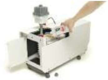
Hinzufügen von Vorpumpenöl (Rotationspumpenöl), 4 L
