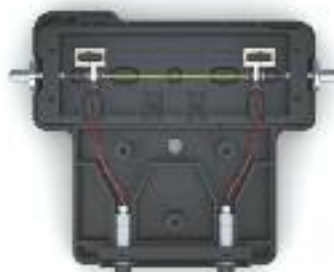
Max-Light Kartuschenzelle, Innenansicht, Lichtweg von 60 mm für hohe Konzentrationen, G4212-60007
