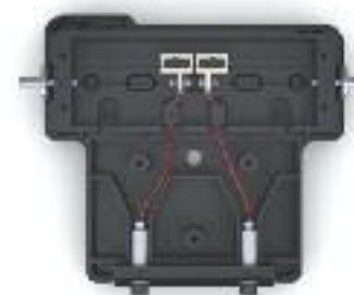
Max-Light HDR-Durchflusszelle, Innenansicht zeigt dünne Schichtdicke von 3,7 mm für hohe Konzentrationen, G4212-60032
