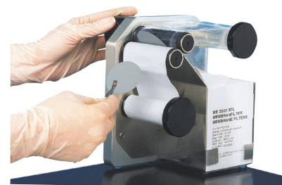
Fig 19: Membrane-Butler membrane dispenser.
